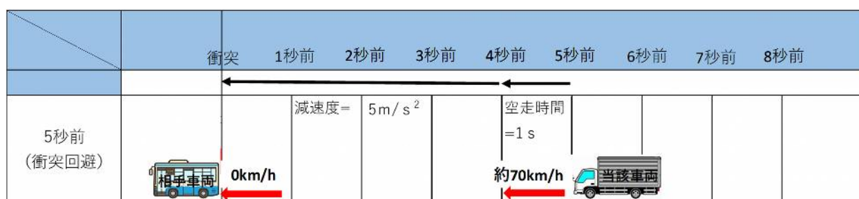
図6-3 衝突回避可能な制動開始時間
