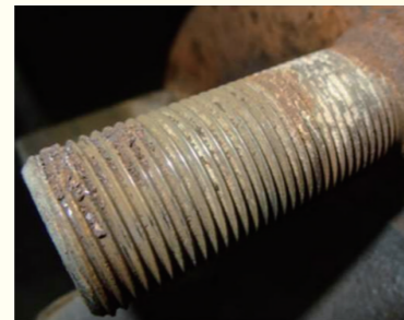
ホイール・ボルトのねじ部に著しいさびや汚れが付着
