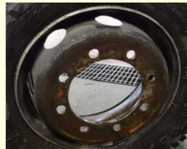
ディスク・ホイールの表面には著しいさびが発生
