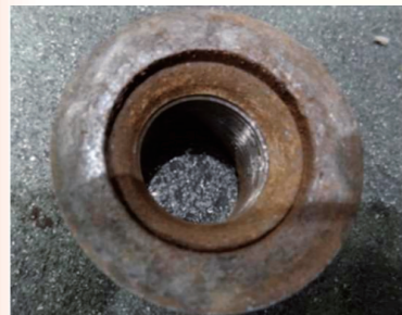
ホイール・ナットの摺動部に、潤滑剤の塗布が確認できない
