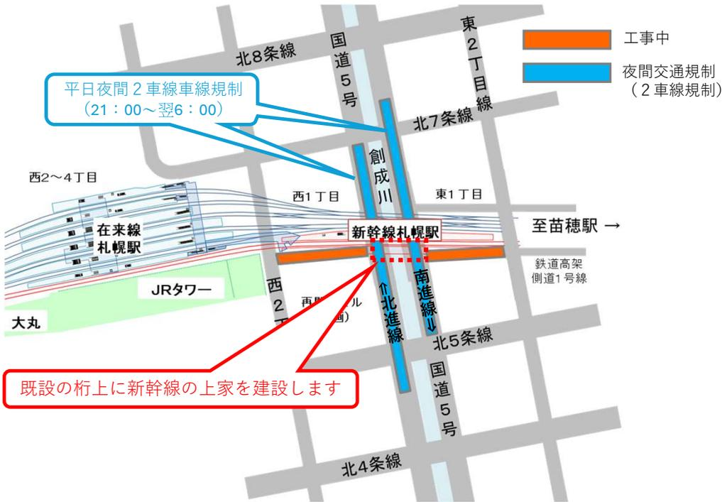
既設の桁上に新幹線の上家を建設します
